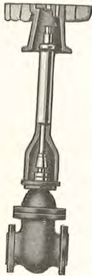
Skydehane med Støbejernshylster, Smedejernsspindel og Støbejerns-Hanedæksel.
